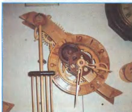
растворителем. Погрузив в лак, кипячу будущую шестеренку на водяной бане. Когда заготовки перестают всплывать, достаю их и высушиваю. После такой обработки механизм деревянных часов становится воистину долговечным. Влажность и температура ему практически не страшны.
